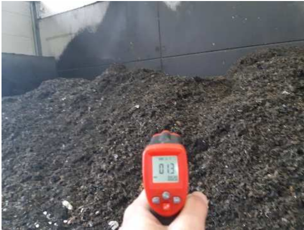
Verifica temperatura rifiuti con termometro a infrarossi
