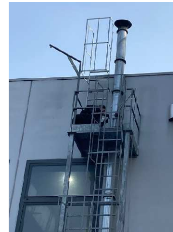
Foto 4: fasi di monitoraggio emissioni, gruppo macinazione filtri olio
