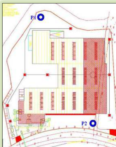
Ubicazione piezometri (P1 monte e P2 valle).
